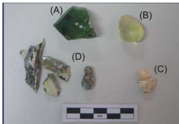
Fig. 2: I campioni analizzati sono reperti riferibili al ciclo di produzione vetraria: A-blocchetto di vetro fuso semilavorato trasparente di colore verde-azzurro scuro (campione 3); B-goccia di vetro semitrasparente verde-azzurra (campione 5); C-scheggia di vetro semitrasparente incolore (campione 4); D-frammenti di manufatti finiti.
