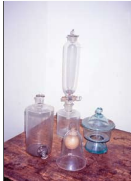
Fig. 2: Strumenti usati per la preparazione dei medicinali. Si distinguono: a) campana con tubolatura, b) bottiglia di Mariotte, c) ipercolatore, d) essiccatore (Collezione Farmacia Bottari, Pisa).
